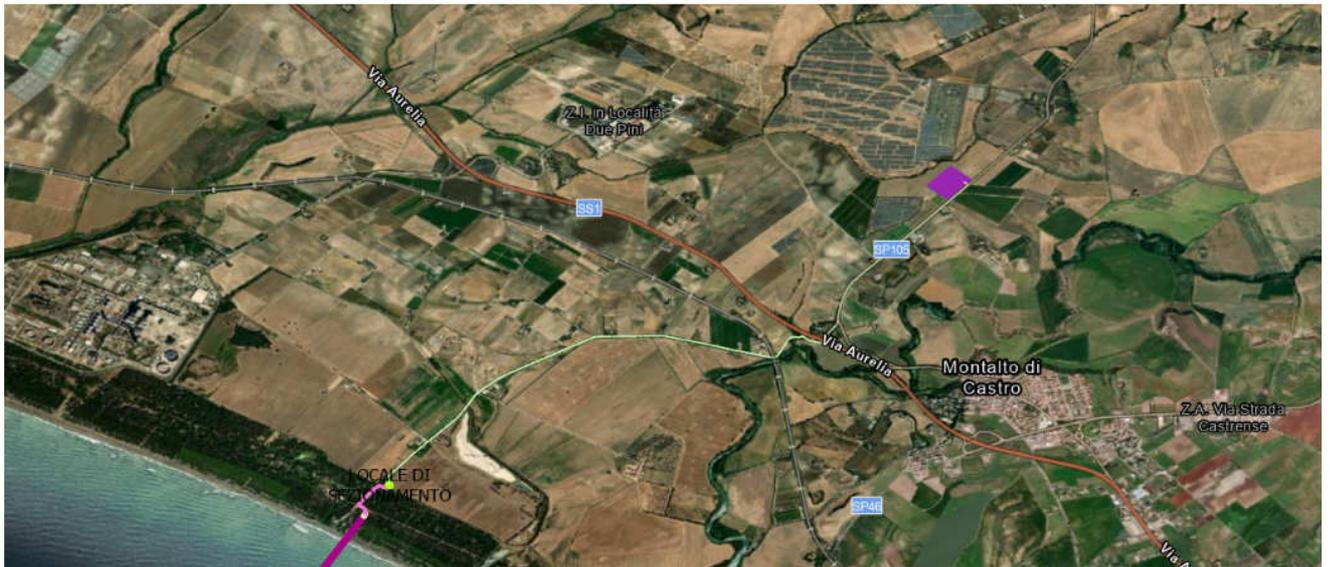
Figura 21: Percorso preliminare cavidotto a 150kV e area della Sottostazione Elettrica di Utenza (IPOTESI 1)
