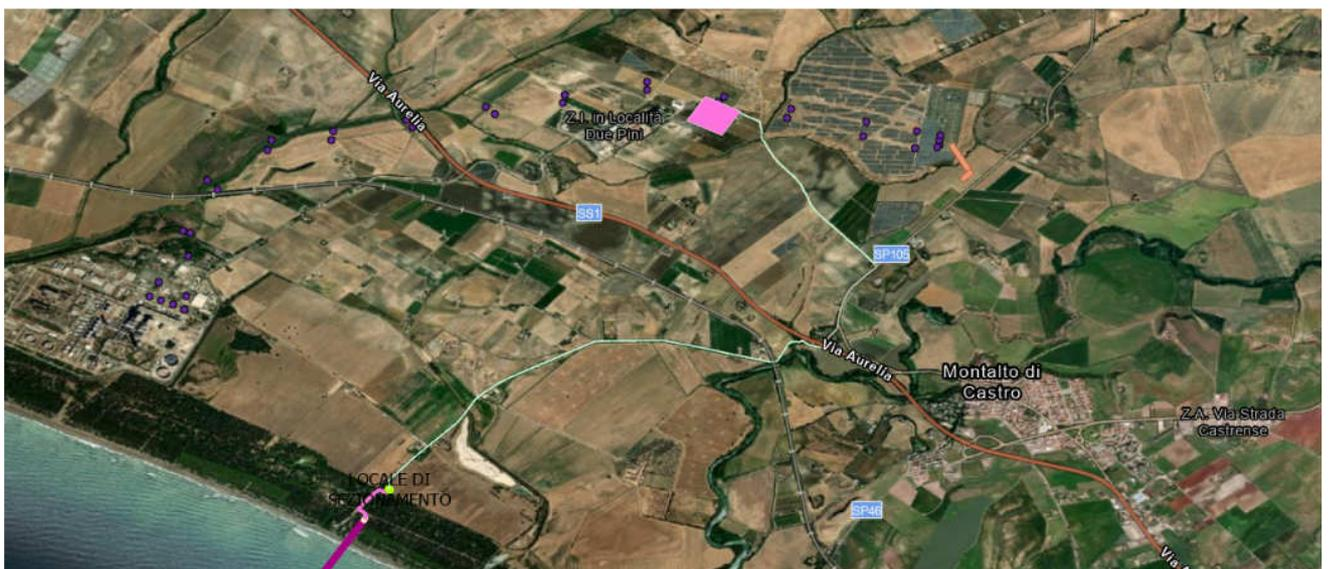
Figura 22: Percorso preliminare cavidotto a 150kV e area della Sottostazione Elettrica di Utenza (IPOTESI 2)
