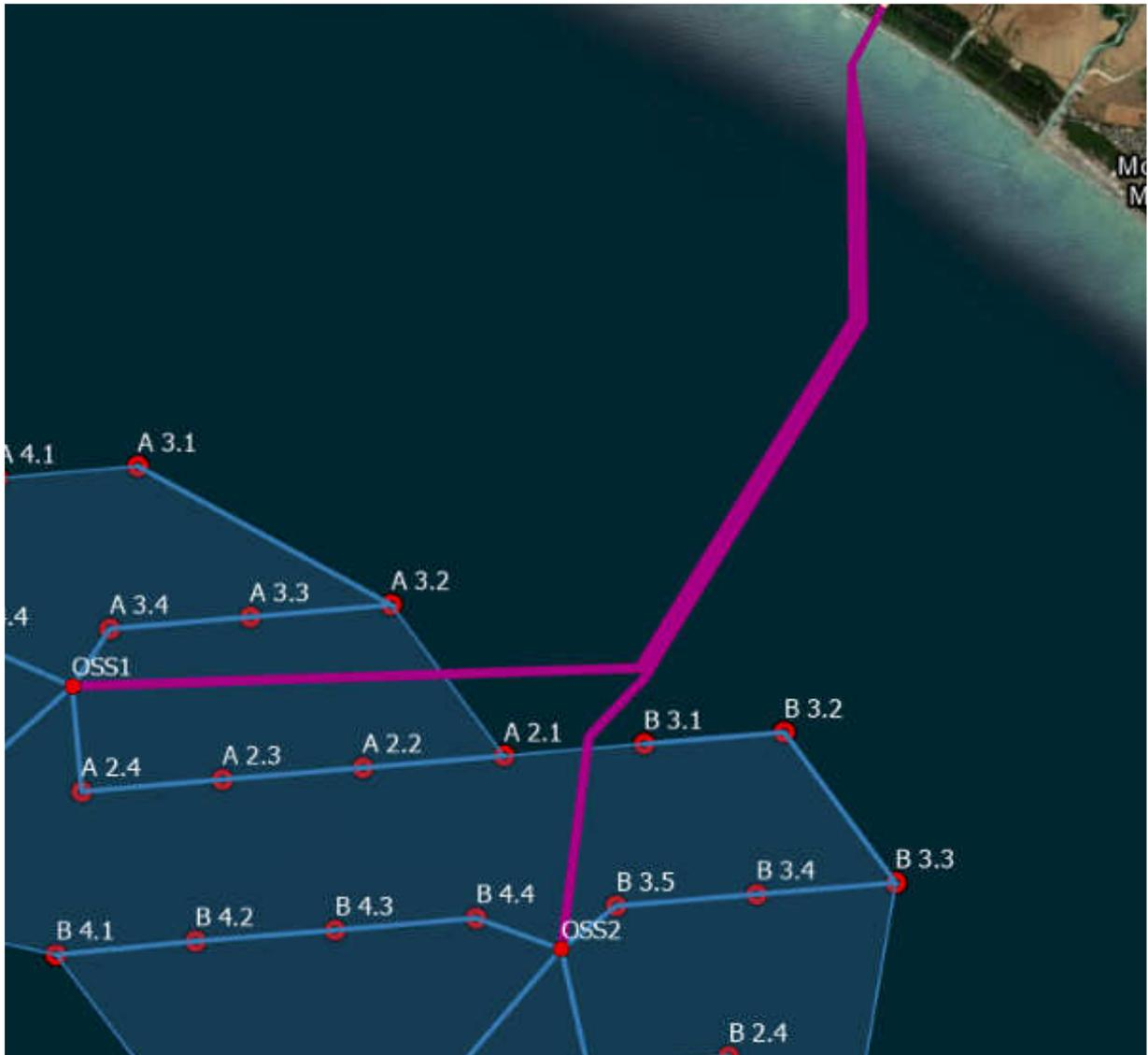
Figura 15: Percorso ipotetico del cavidotto sottomarino (linea viola)
