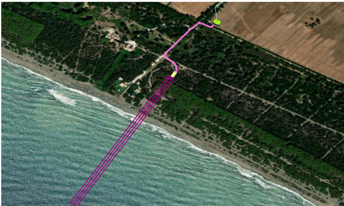
Figura 5: Dettaglio della vista dell'approccio alla costa, della buca giunti e dello stallo di sezionamento
