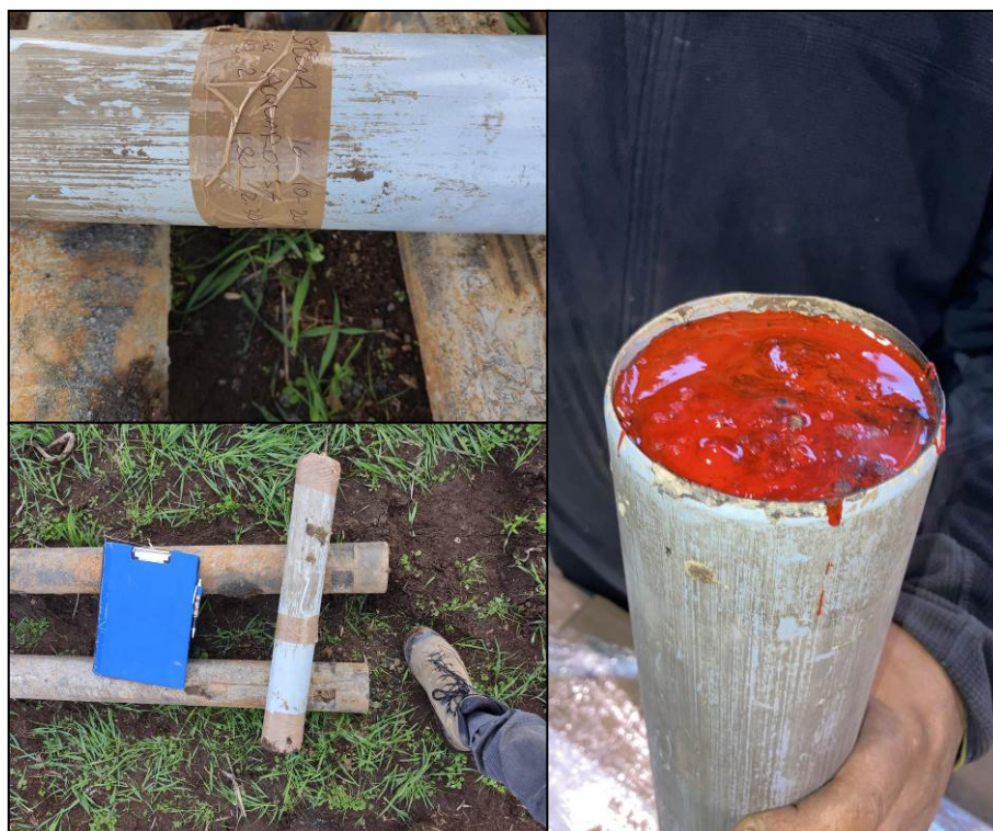
Prelievo e confezionamento del campione indisturbato
