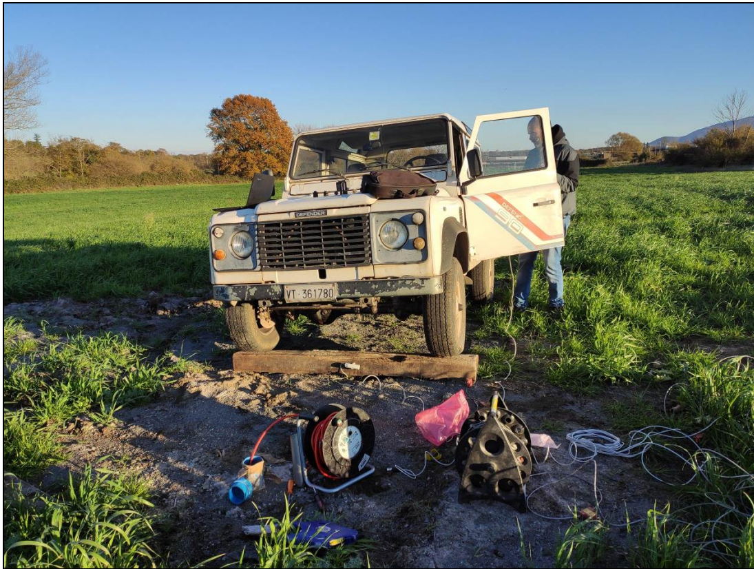
Realizzazione prova Down-Hole
