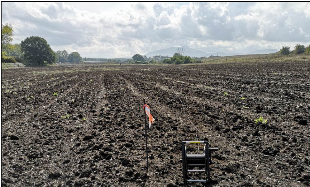
Ubicazione array sismico MASW 2 con il geofono 17 ubicato nei pressi del limite Nord-Occidentale dell'area.
