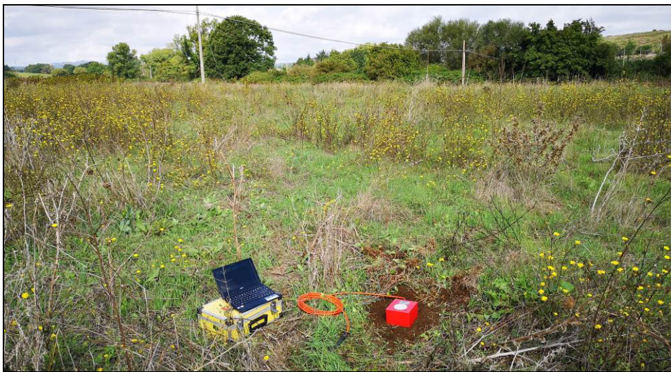
Esecuzione della misura di microtremori a stazione singola MT1.
